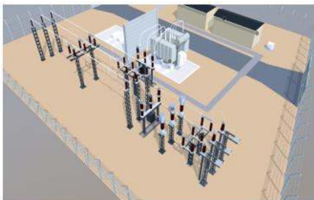
Hình 8 Tổng quát giao diện chính của mô hình thông tin công trình trạm biến áp
